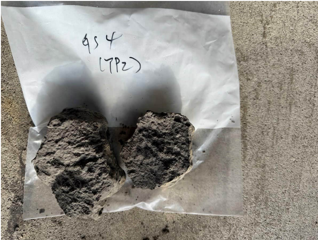
Photo 14: Clayey Silt Till
